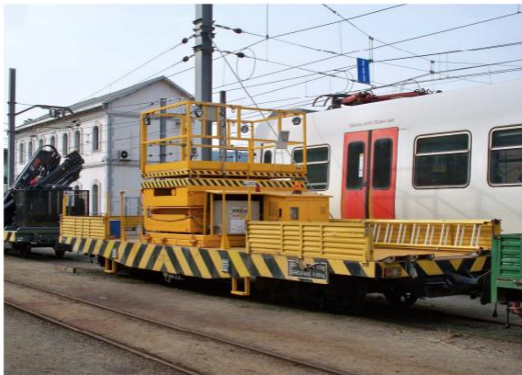
El vagó PM-02 amb la nova torre a l'estació de Martorell. Foto J. C. Salmeron (2012).
