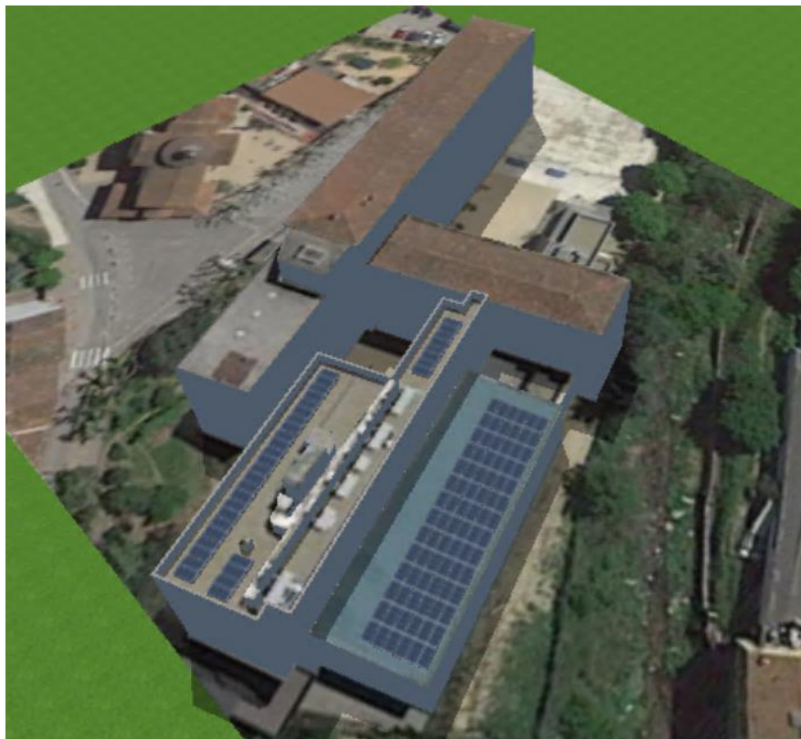
Figura 4 Implantació 3D de simulació fotovoltaica. Font: Infraestructures.cat
