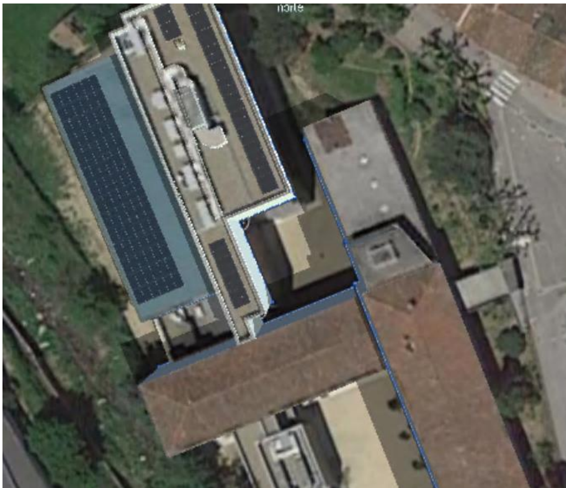
Figura 2 Imatge simulació fotovoltaica de PVSOL. Font: Infraestructures.cat
