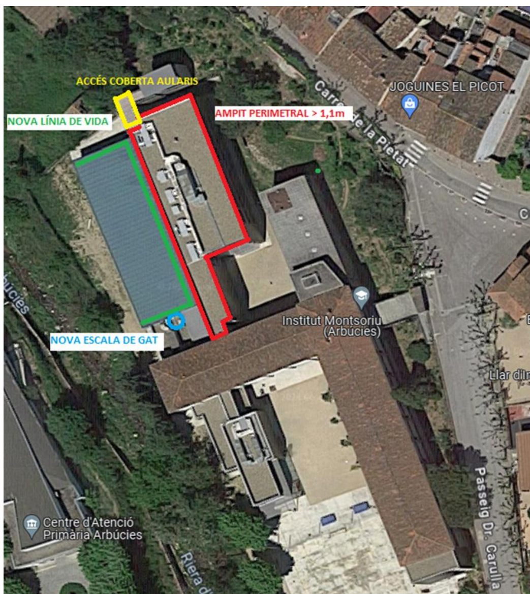
Figura 21 Proteccions col·lectives i accessos durant la fase d'execució. Font: Infraestructures.cat
