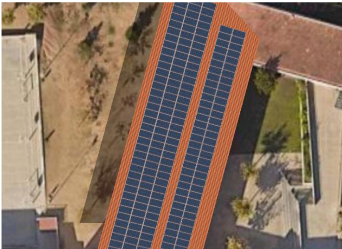
Figura 2 Imatge simulació fotovoltaica de PVSOL. Font: Infraestructures.cat
