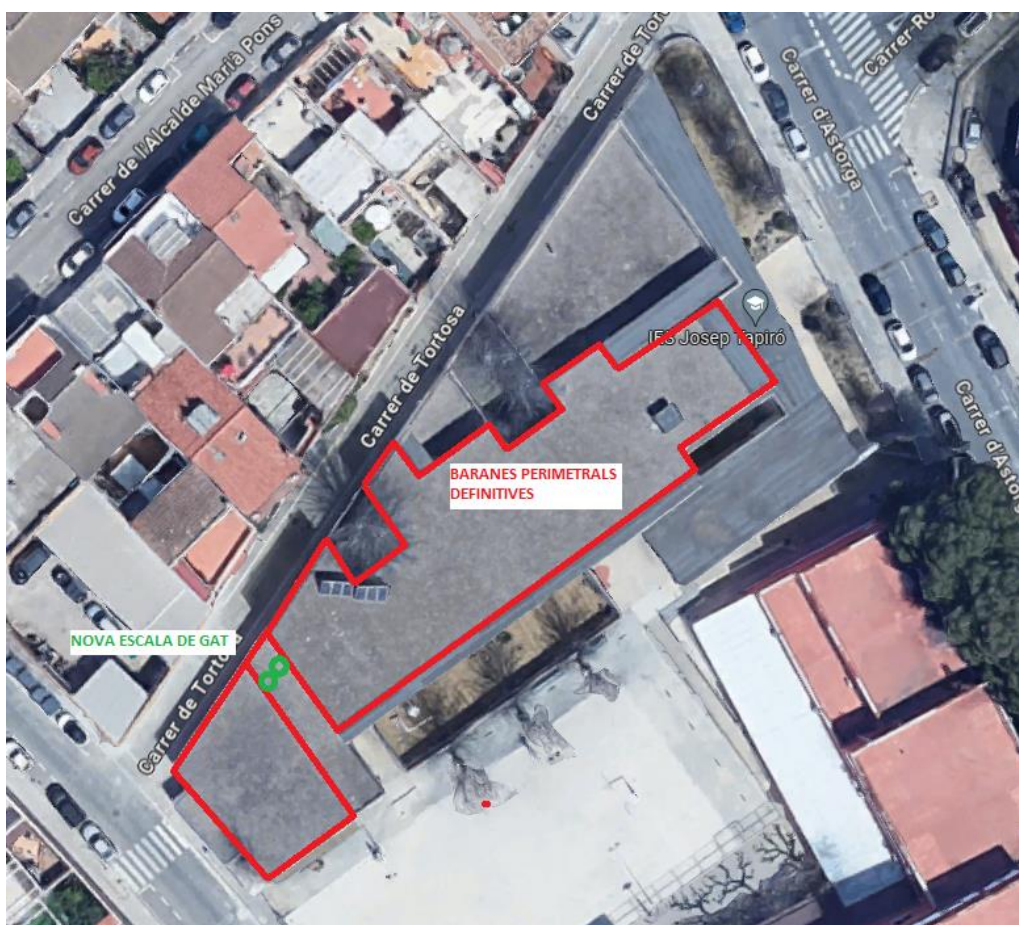
Figura 19. Proteccions col·lectives i accessos. Font: Infraestructures.cat
