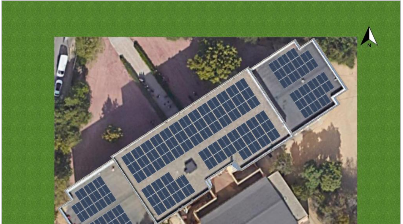
Figura: Vista general, Planificación 3D
