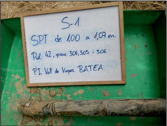
Assaig SPT realitzat entre 1,00 i 1,07 m.
