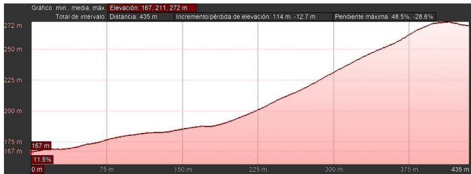
Perfil longitudinal de la nova canonada
