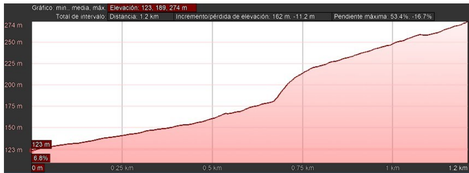
Perfil longitudinal de la nova canonada
