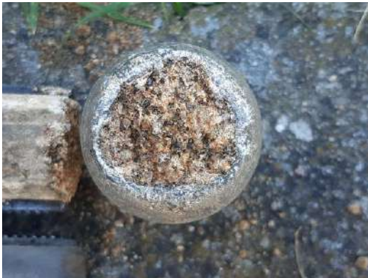
Foto 9. Detall de la punta del SPT extret a 1.00 m de fondària.
