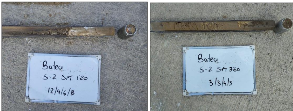
Imatge 4-1. Nivell A, Argiles i llims amb sorra i alguna grava.
