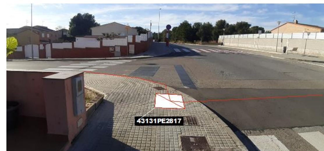
Fig 32. Nova microrasa del tipus 6c20 des del pericó en projecte 43131PE2817
