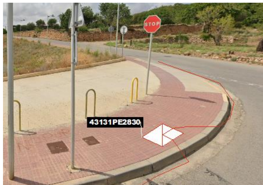
Fig 42. Nova microrasa del tipus 6c20 des del pericó en projecte 43131PE2830
