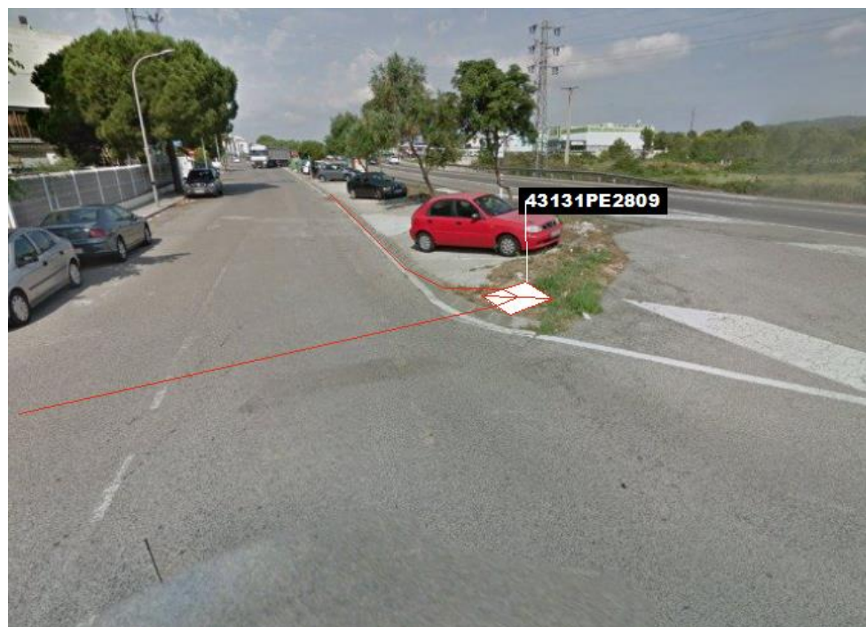
Fig 25. Nova microrasa del tipus 6c20 des del pericó en projecte 43131PE2809
