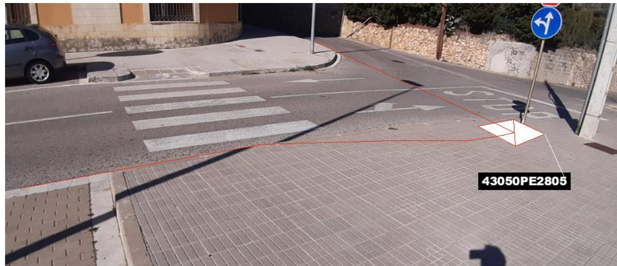
Fig 53. Nova microrasa del tipus 6c20 des del pericó en projecte 43050PE2805
