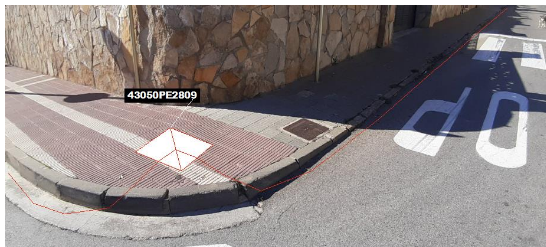
Fig 57. Nova microrasa del tipus 6c20 des del pericó en projecte 43050PE2809
