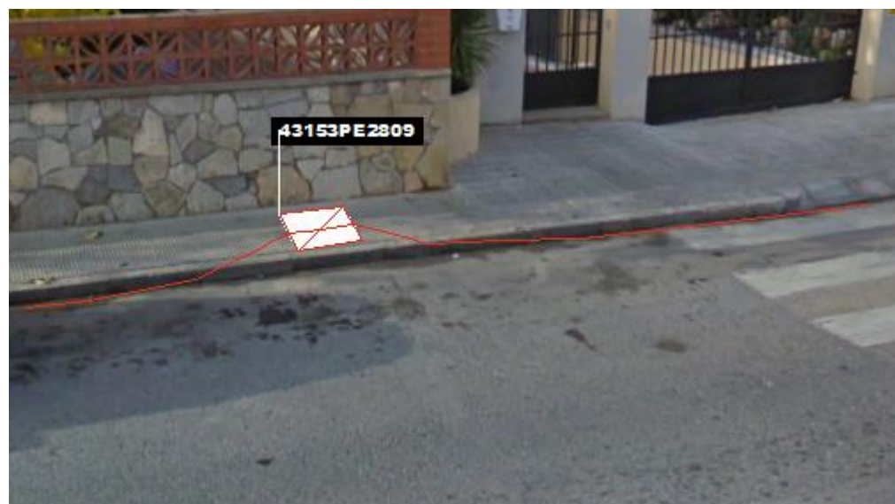
Fig 73. Nova microrasa del tipus 6c20 des del pericó en projecte 43153PE2809
