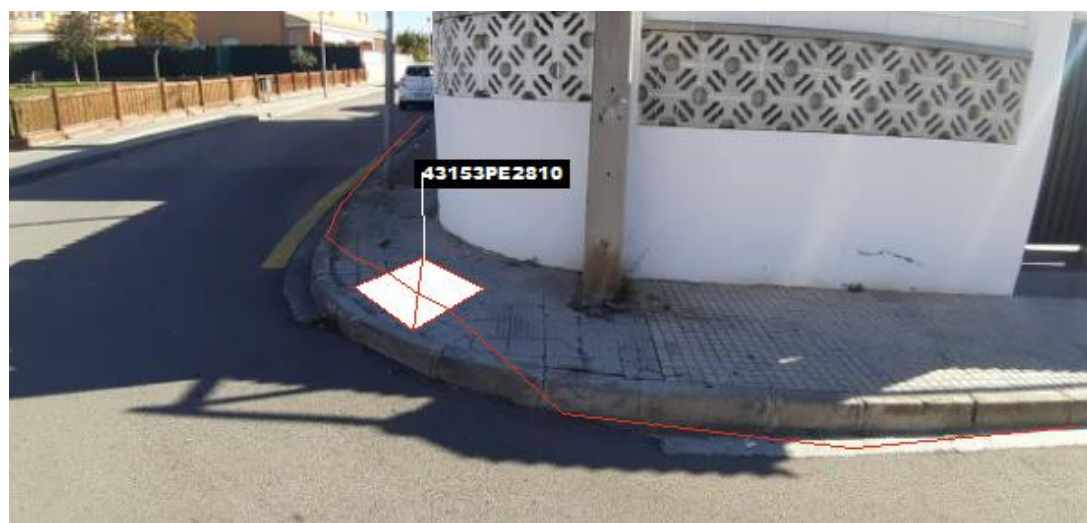
Fig 74. Nova microrasa del tipus 6c20 des del pericó en projecte 43153PE2810
