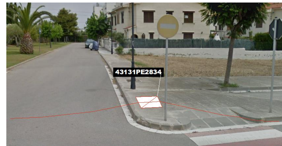
Fig 48. Nova microrasa del tipus 6c20 des del pericó en projecte 43131PE2834
