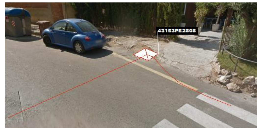
Fig 72. Nova microrasa del tipus 6c20 des del pericó en projecte 43153PE2808
