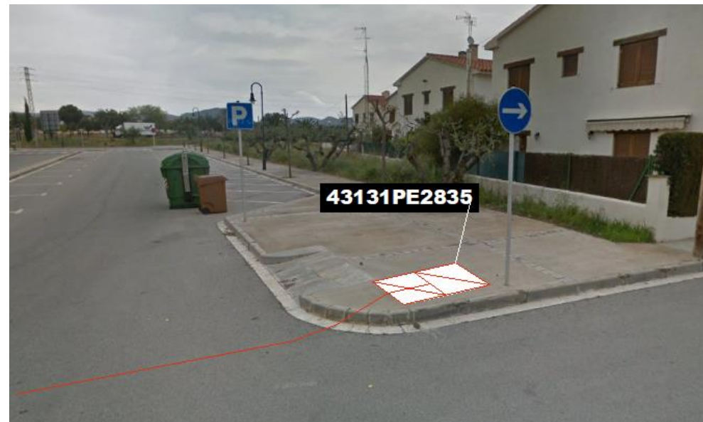
Fig 49. Nova microrasa del tipus 6c20 des del pericó en projecte 43131PE2835
