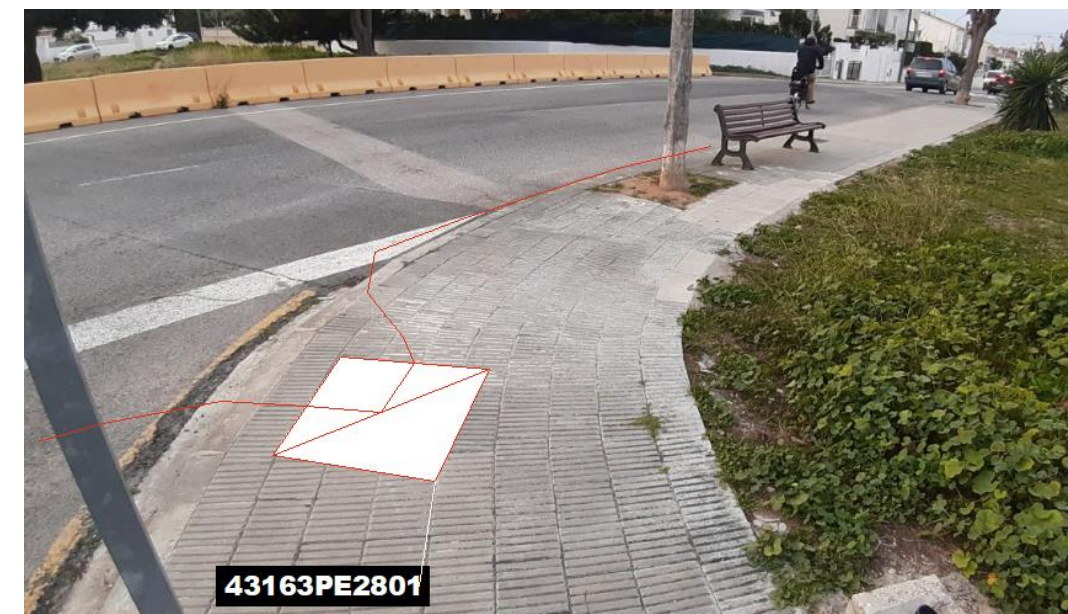
Fig 3. Nova microrasa del tipus 6c20 des del pericó en projecte 43163PE2801
