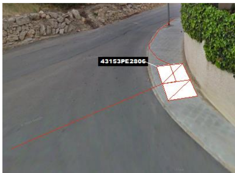
Fig 70. Nova microrasa del tipus 6c20 des del pericó en projecte 43153PE2806
