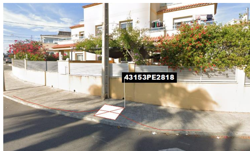
Fig 82. Nova microrasa del tipus 6c20 des del pericó en projecte 43153PE2818
