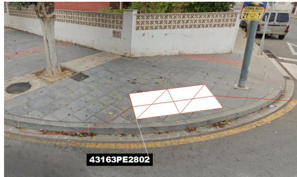
Fig 4. Nova microrasa del tipus 6c20 des del pericó en projecte 43163PE2802
