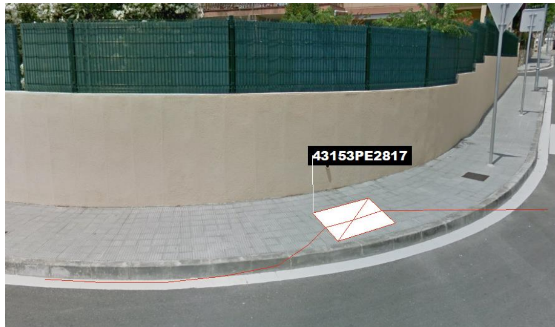
Fig 81. Nova microrasa del tipus 6c20 des del pericó en projecte 43153PE2817
