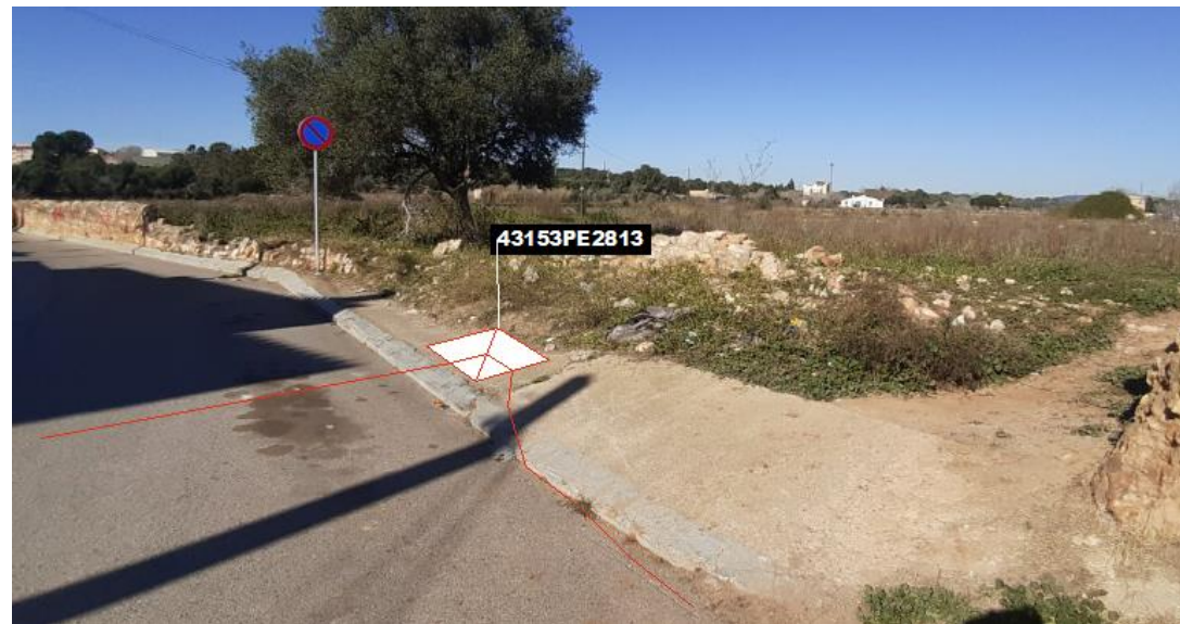
Fig 77. Nova microrasa del tipus 6c20 des del pericó en projecte 43153PE2813
