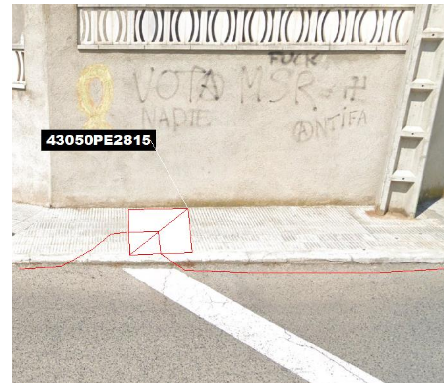
Fig 63. Nova microrasa del tipus 6c20 des del pericó en projecte 43050PE2815
