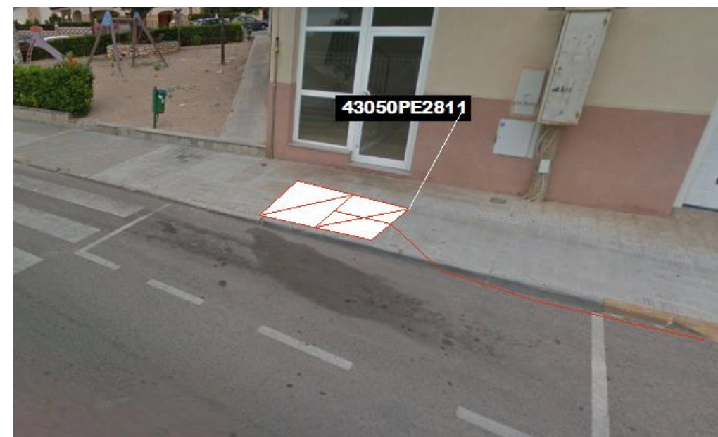
Fig 59. Nova microrasa del tipus 6c20 des del pericó en projecte 43050PE2811
