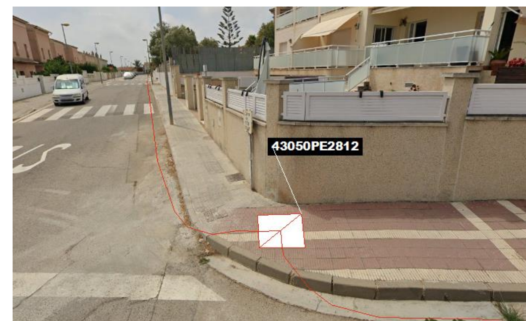
Fig 60. Nova microrasa del tipus 6c20 des del pericó en projecte 43050PE2812
