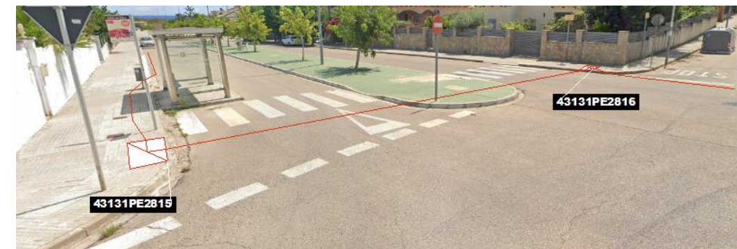
Fig 31. Nou encreuament des del pericó en projecte (pericó tipus B2) 43131PE2815, fins al pericó projectat en projecte (pericó tipus C2) 43131PE2816
