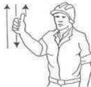
4 Levantar el aguilón o pluma lentamente.
