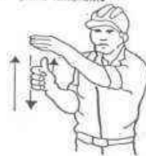
4 Levantar el aguilón o pluma lentamente.
