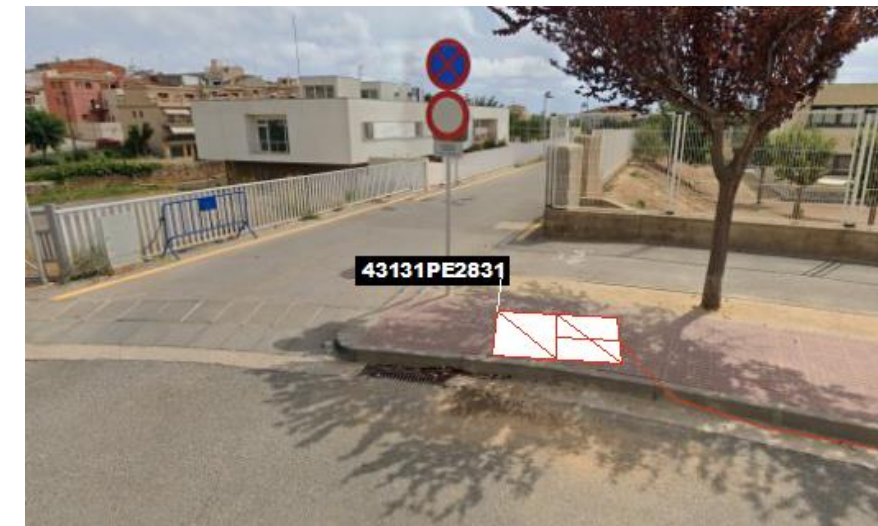
Fig 43. Nova microrasa del tipus 6c20 des del pericó en projecte 43131PE2831
