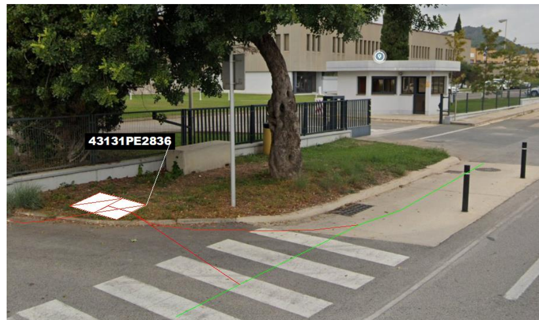
Fig 46. Nova microrasa del tipus 6c20 des del pericó en projecte 43131PE2836. intercepció canalització existent de la DIPTA.
