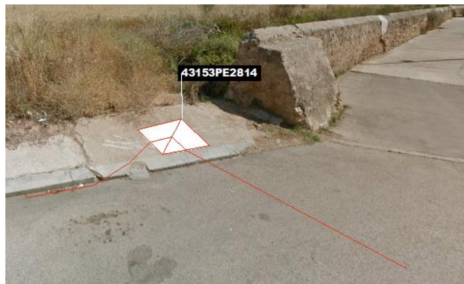
Fig 78. Nova microrasa del tipus 6c20 des del pericó en projecte 43153PE2814
