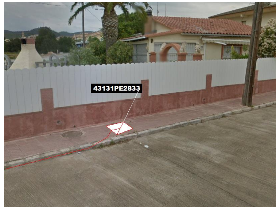
Fig 45. Nova microrasa del tipus 6c20 des del pericó en projecte 43131PE2833
