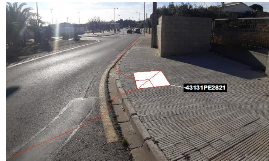
Fig 35. Nova microrasa del tipus 6c20 des del pericó en projecte 43131PE2821
