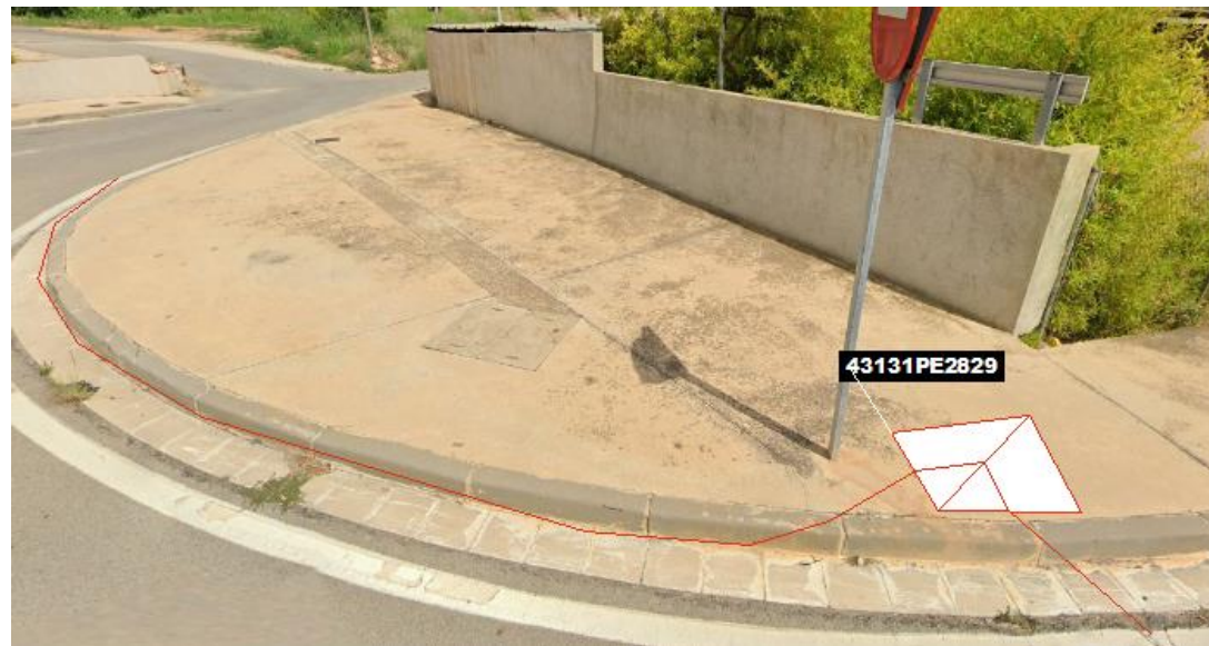
Fig 41. Nova microrasa del tipus 6c20 des del pericó en projecte 43131PE2829
