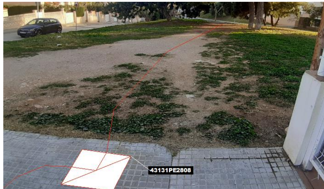
Fig 24. Nova microrasa del tipus 6c20 des del pericó en projecte 43131PE2808
