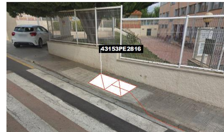
Fig 80. Nova microrasa del tipus 6c20 des del pericó en projecte 43153PE2816
