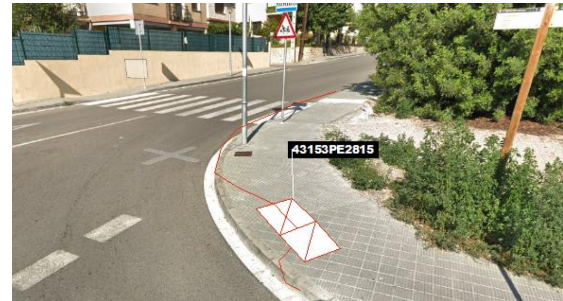
Fig 79. Nova microrasa del tipus 6c20 des del pericó en projecte 43153PE2815
