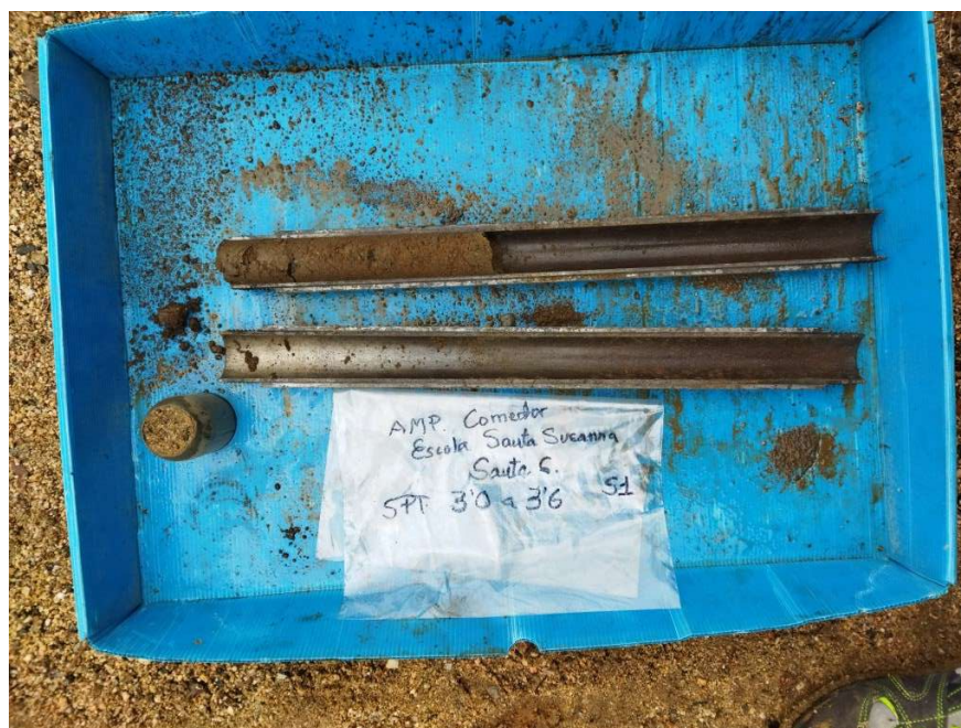
Assaig SPT de -3,0 a -3,6 m. de profunditat en sondeig (S1)
