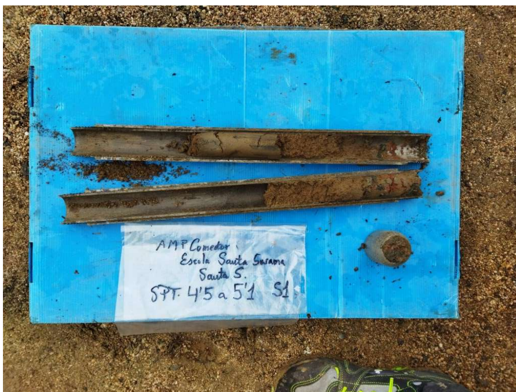
Assaig SPT de -4,5 a -5,1 m. de profunditat en sondeig (S1)
