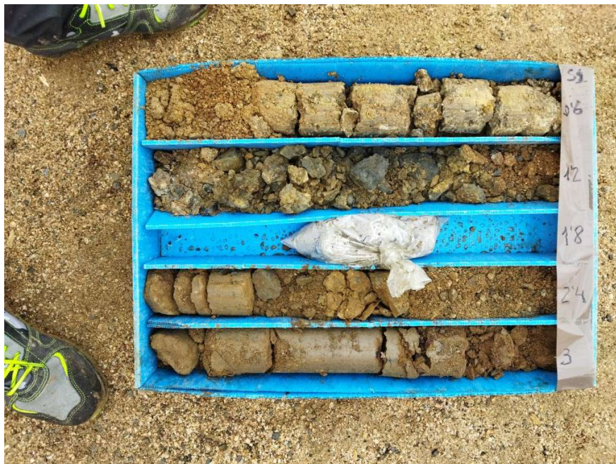
Caixa portamostres corresponent al sondeig (S1) de +0,0 a -3,0 m. de profunditat.
