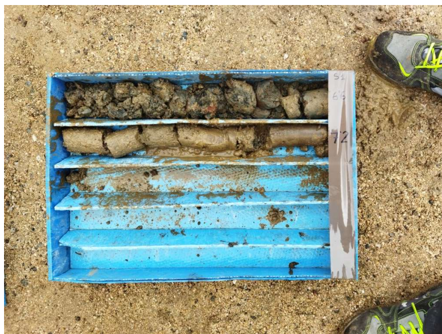
Caixa portamostres corresponent al sondeig (S1) de -6,0 a -7,2 m. de profunditat.
