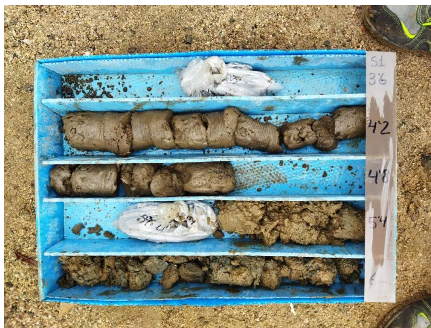
Caixa portamostres corresponent al sondeig (S1) de -3,0 a -6,0 m. de profunditat.
