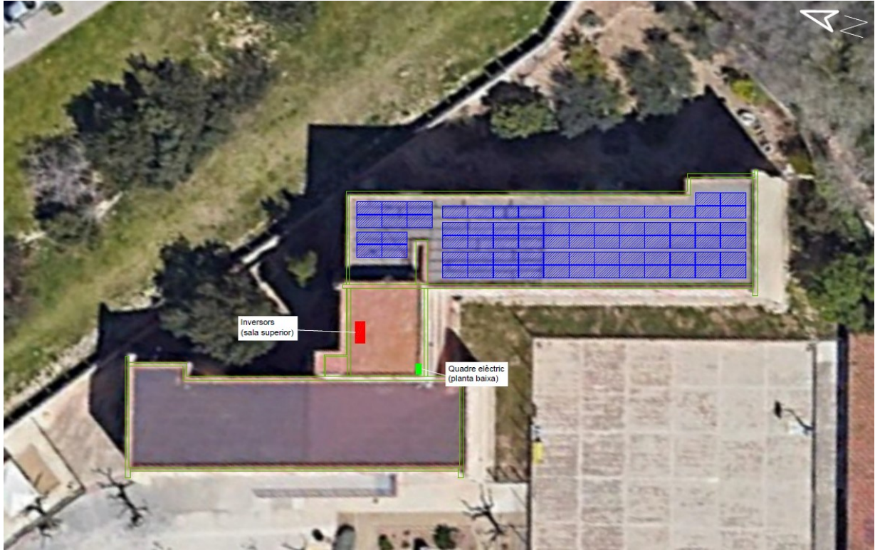
Ubicació captadors i inversors en planta.
