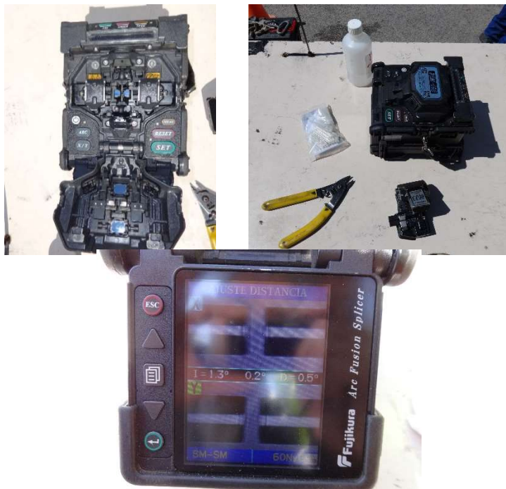
Detalls de maquinària de fusió, accessoris i arc voltàic en execució.
