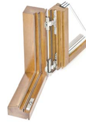
Fusteria exterior de fusta, amb 3 juntes de goma, cambres, vidre climatit i ferratges d'acer inoxidable
