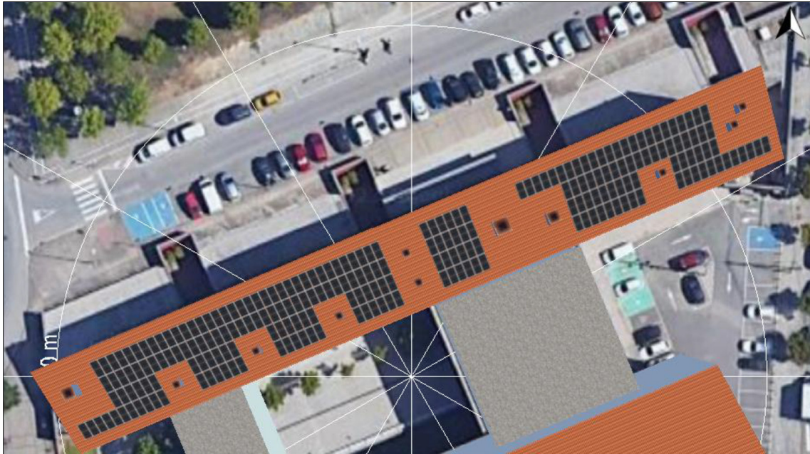
Il·lustració 3: Instal·lació fotovoltaica de l'Edifici Torre dels Frares.
