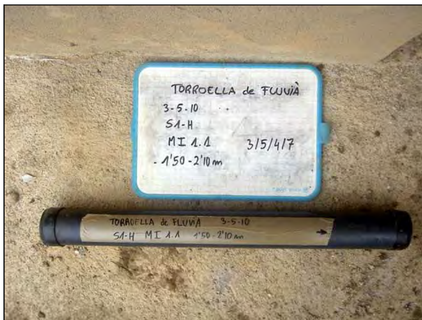
Foto 3: Mostra inalterada MI-1.1 extreta d'1,5 a 2,1 m de profunditat.
