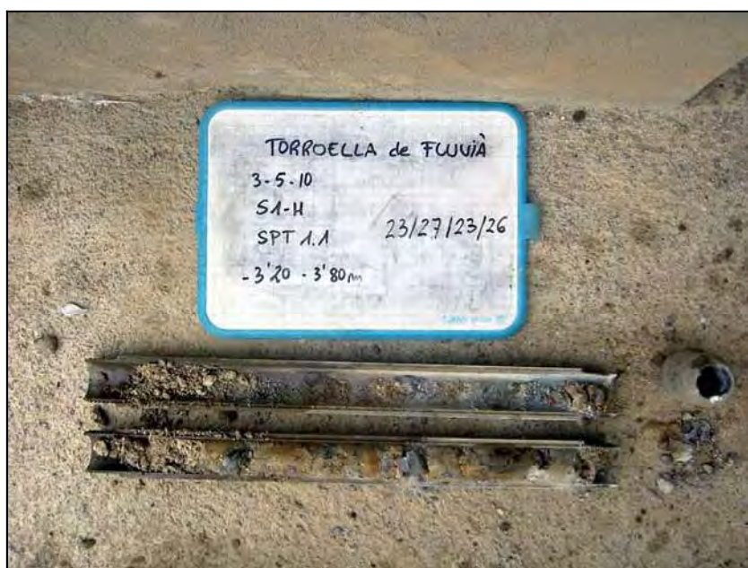
Foto 4: Material extret de l'assaig SPT-1.1 de 3,2 a 3,8 m de profunditat.
