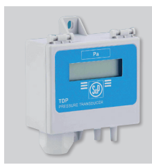
TDP-S/TDP-D/TDP-PI Transmisores de presión. Se utilizan para controlar la presión en sistemas de ventilación en presión constante. Permiten la lectura de la diferencia de presiones entre dos puntos y la transforman en una señal eléctrica apta para los diferentes equipos de control.
