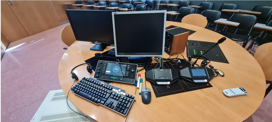
Taula del docent amb el nou sistema d'interpretació, Consoles Bosch DCNM-IDESK, DCNM-LSSL i DCNM-LSDU
