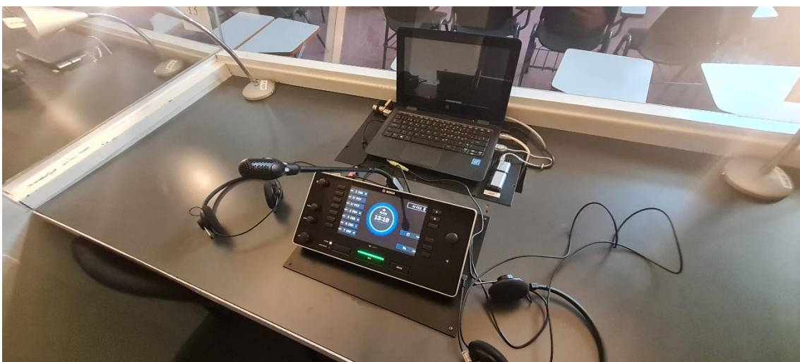
Cabina d'Interpretació amb el nou equipament. Consola Bosch DCNM-IDEK.
