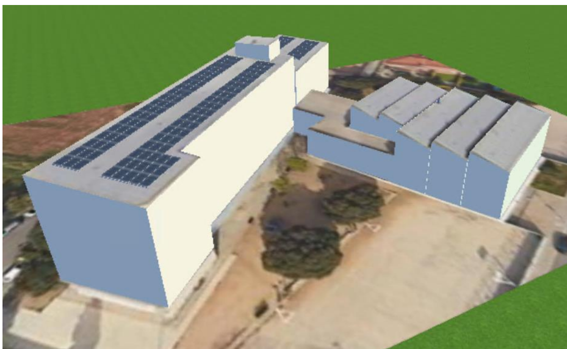
Figura 2. Imatge simulació fotovoltaica de PVSOL. Font: Infraestructures.cat
