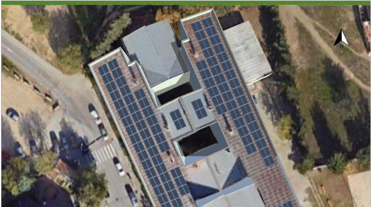
Figura: Vista general, Planificación 3D
