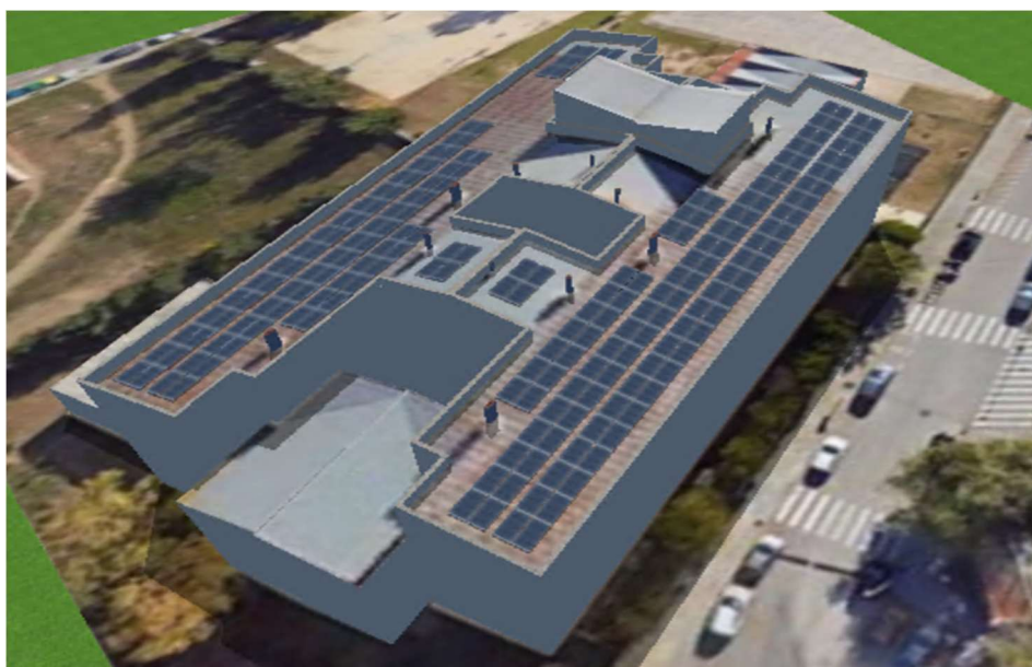
Figura 4 Implantació 3D de simulació fotovoltaica. Font: Infraestructures.cat
