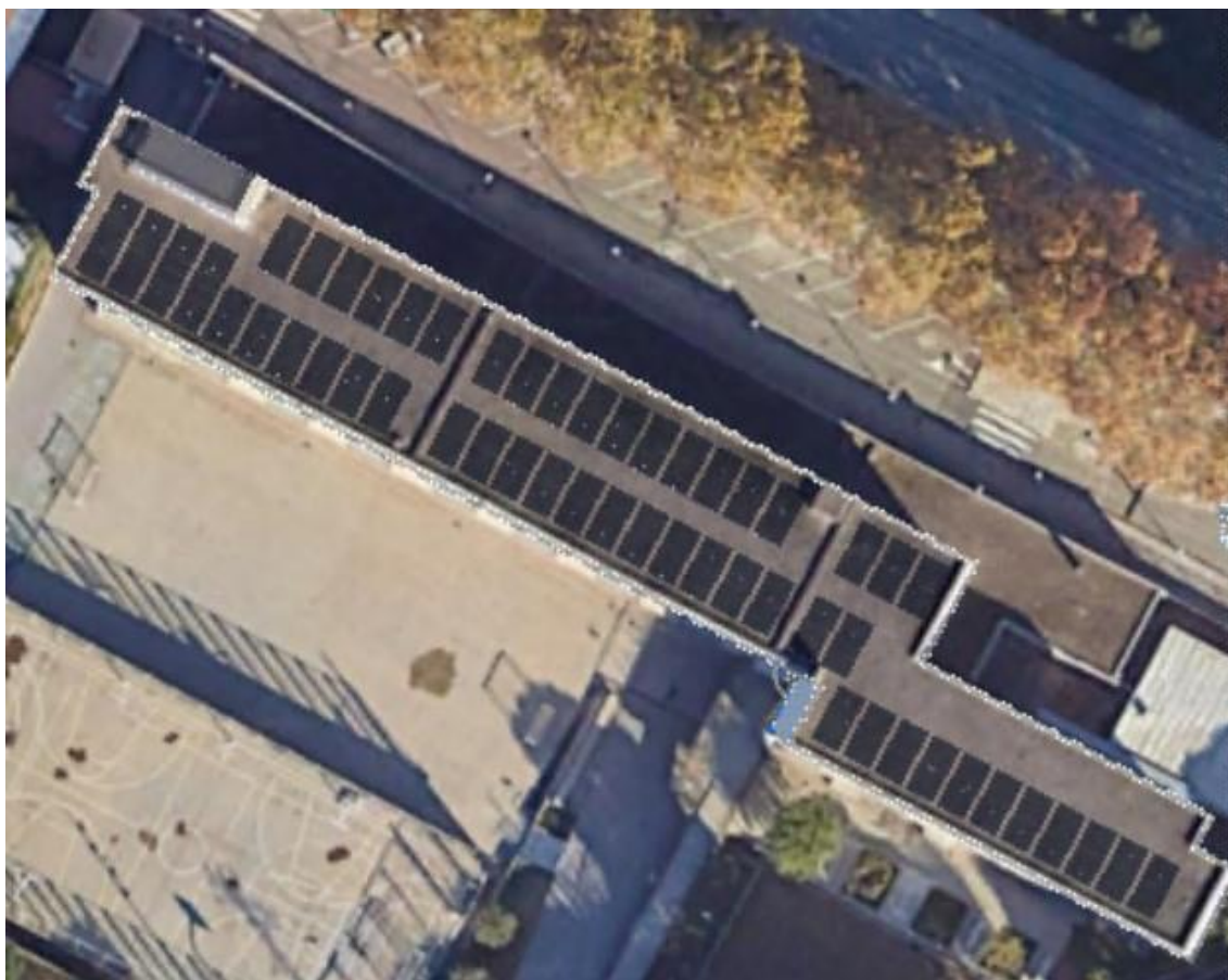
Figura 2 Imatge simulació fotovoltaica de PVSOL. Font: Infraestructures.cat
