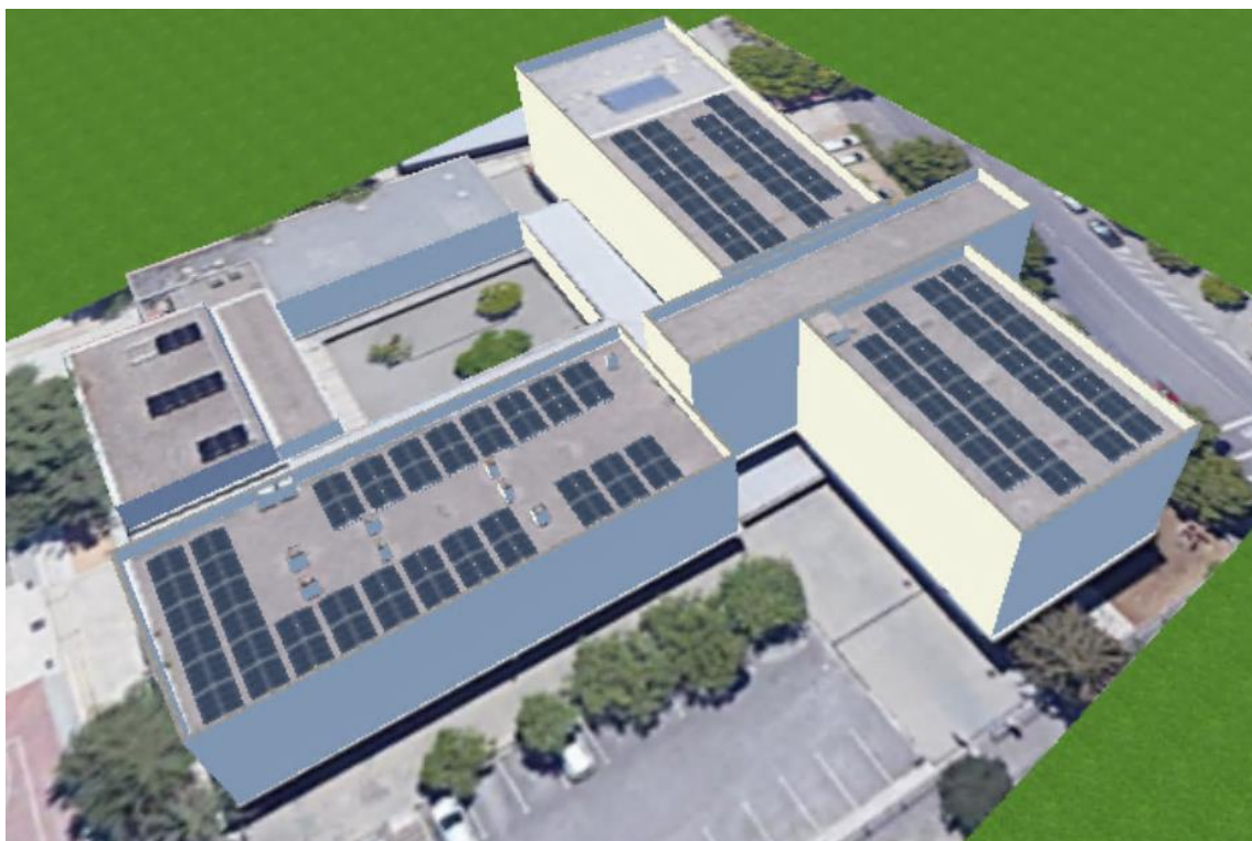
Figura 2 Imatge simulació fotovoltaica de PVSOL. Font: Infraestructures.cat
