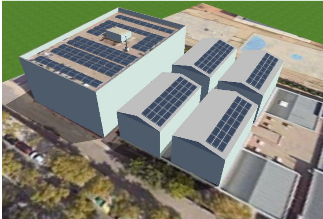
Figura 5 Implantació 3D de simulació fotovoltaica. Font: Infraestructures.cat
