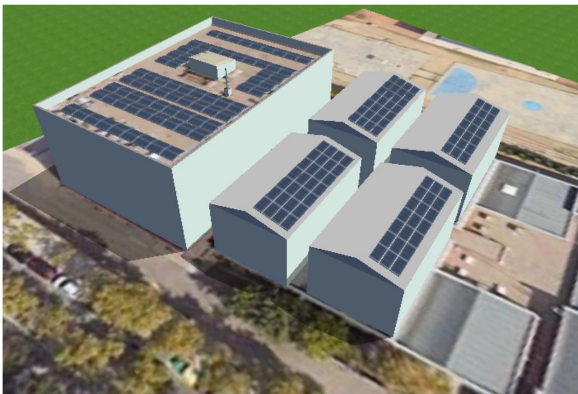
Figura 2 Imatge simulació fotovoltaica de PVSOL. Font: Infraestructures.cat
