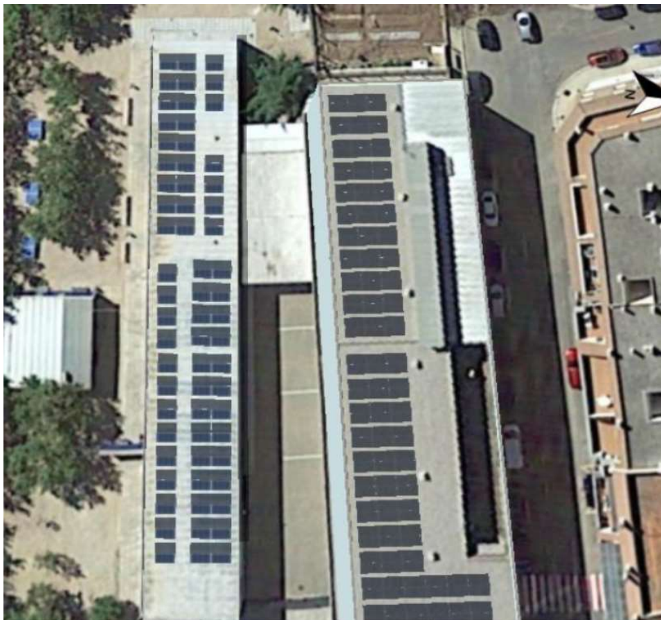
Figura 4 Implantació 3D de simulació fotovoltaica. Font: Infraestructures.cat
