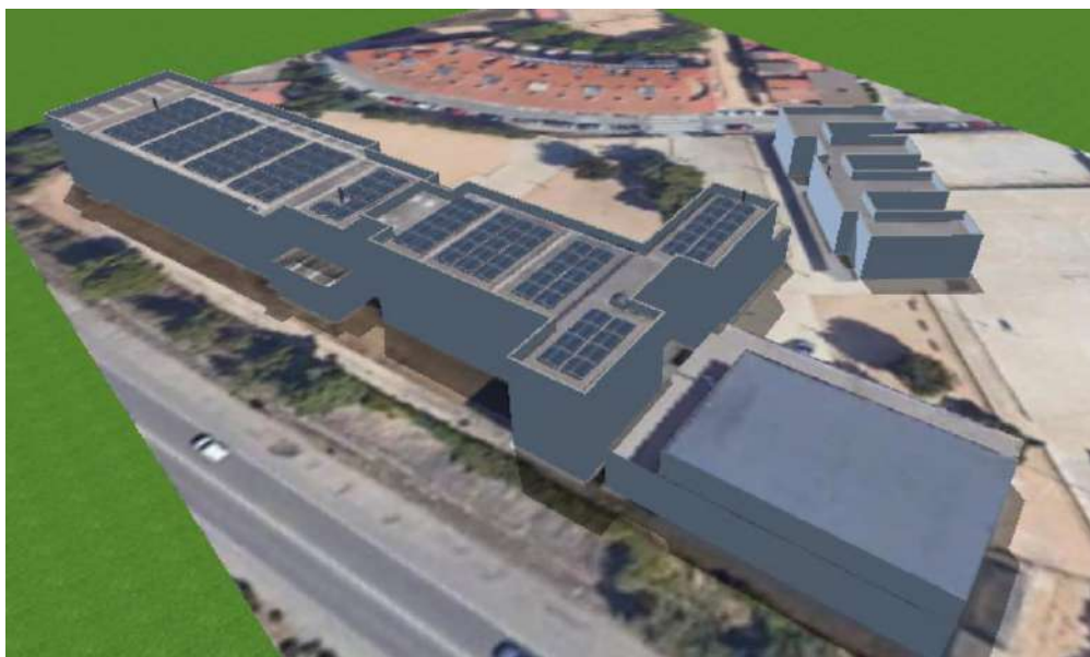
Figura 2 Imatge simulació fotovoltaica de PVSOL. Font: Infraestructures.cat
