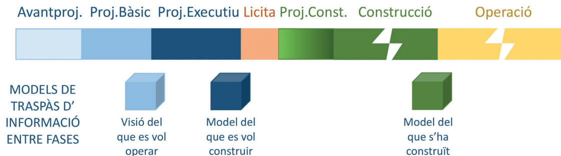
Fig. núm. 4: Procés actual de traspàs d'informació entre fases en base a models BIM
