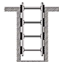
RASES AMB APUNTALAMENT PER SOBRECÀRREGA
