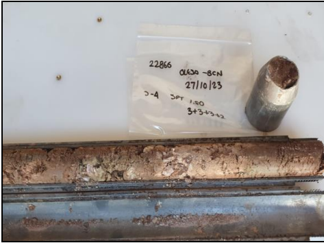
Foto 11: Sondeig S-3, SPT a 1,8 metres.
