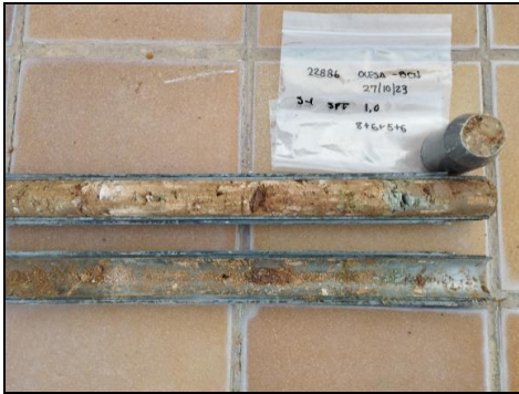
Foto 2: Sondeig S-1, SPT a 1 metre.
