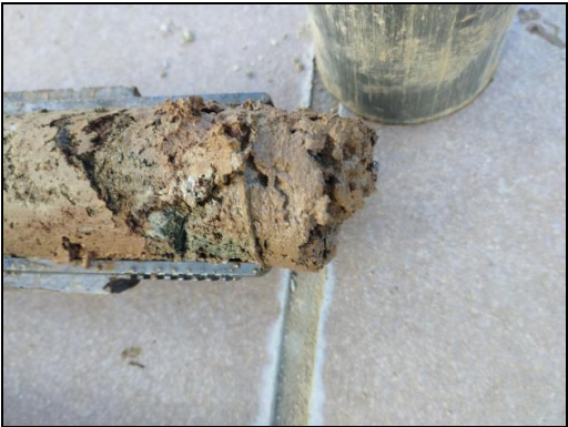
Detall dels materials de la capa R, amb elevada humitat.
