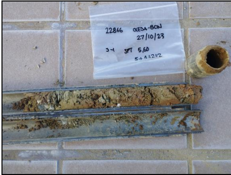
Foto 4: Sondeig S-1, SPT a 5,6 metres.
