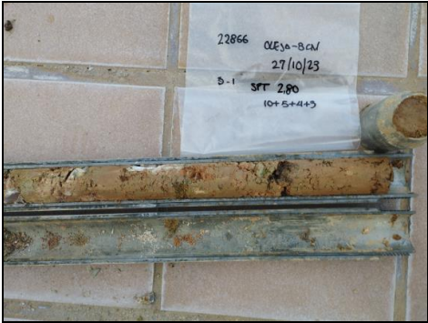
Foto 3: Sondeig S-1, SPT a 2,8 metres.
