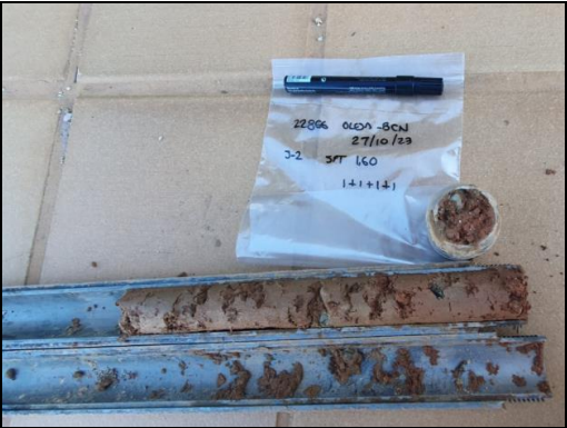
Detall dels materials de la capa R, amb elevada humitat.
