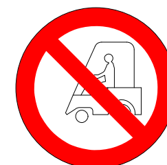
PROHIBIT EL PAS A CARRETO
