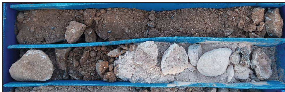
Aspecte dels materials de rebliment de caràcter heterogeni de la capa R, incloent alguns blocs de roca.
