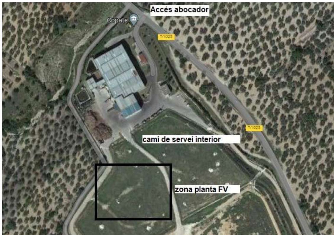
Figura 6. Accessos exteriors i interiors a la instal·lació FV
