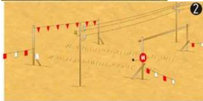
Pòrtic de balisament, protecció de línies elèctriques
