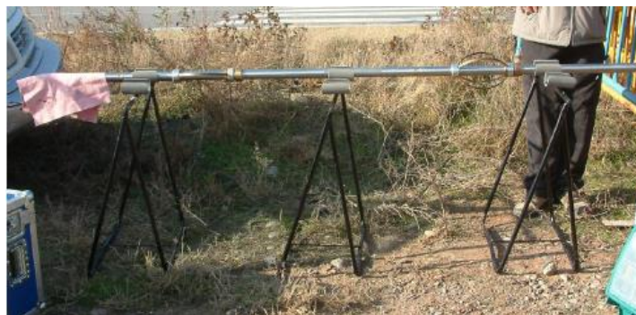
Imatge 14. Exemple de sonda multiparamètrica.
