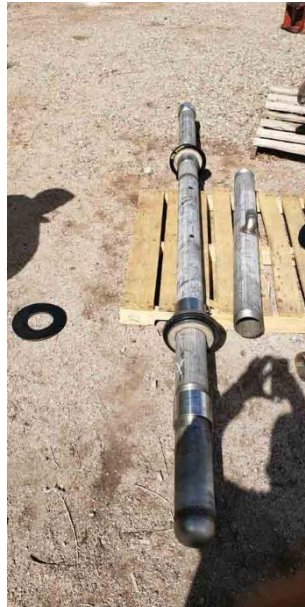
Imatge 12. Doble obturador de swabbing con cabezal air-lift.
