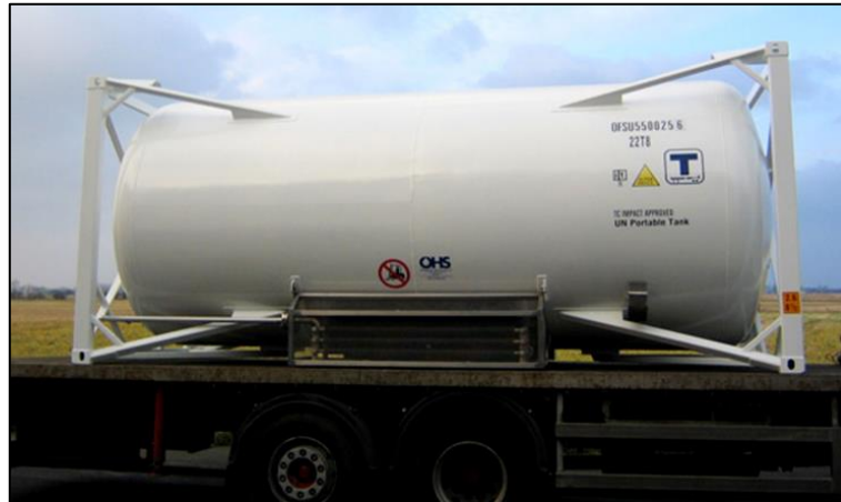
Imatge 9. Exemple de tanc criogènic de CO 2
