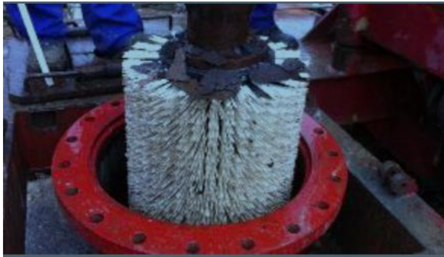
Imatge 7. Exemple d'eina de raspallat mecànic
