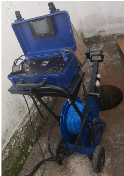
Imatge 13. Exemple de videinspecció
