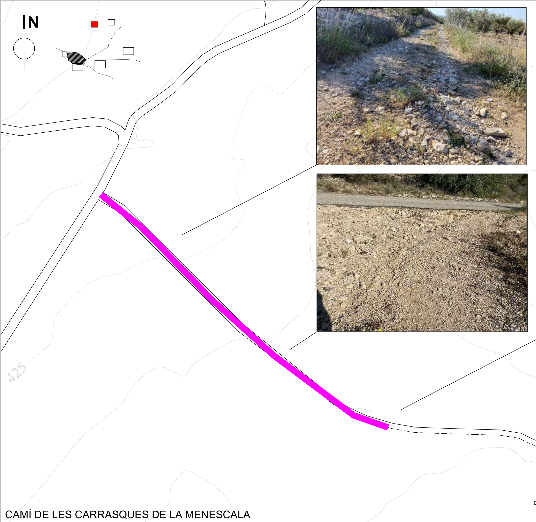
DESGAST CAPA RODADURA DEGUT A L'ACCIÓ EROSIVA DEL TEMPORAL DE PLUGES
