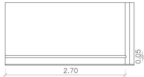
DI-1 (BARANA FE-5) PLANTA PRIMERA ALÇADA 90CM, TUB D'ACER AMB PROTECCIÓ ANTIOXIDANT I PINTURA COLOR 1 UNITAT
