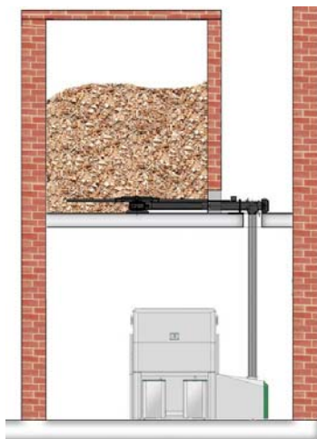
Dibuix orientatiu del sistema d'aspiració del pellet de la sitja a la caldera
