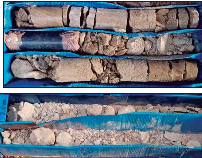
Diferents aspectes dels materials argilosos més o menys litificats del substrat competent de la capa A. A dalt, corresponent als trams més argilosos, i a baix, als nivells carbonatats cimentats, que amb el procés de perforació es recuperen disgregats.
