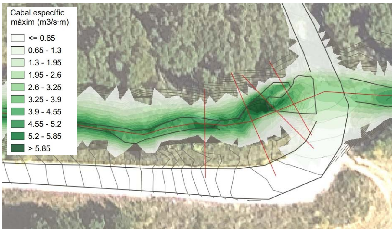
Cabal específic màxim per Q100 en l'estat actual En gris clar, les corbes de nivell de l'estat actual. En gris fosc, el límit actual de la llera i els camins. En vermell, les seccions estudiades en els plànols.
