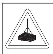
¡PELIGRO! CARGAS SUSPENDIDAS
