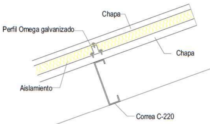
Ilustración 2. Esquema del sistema de cubrimiento propuesto
