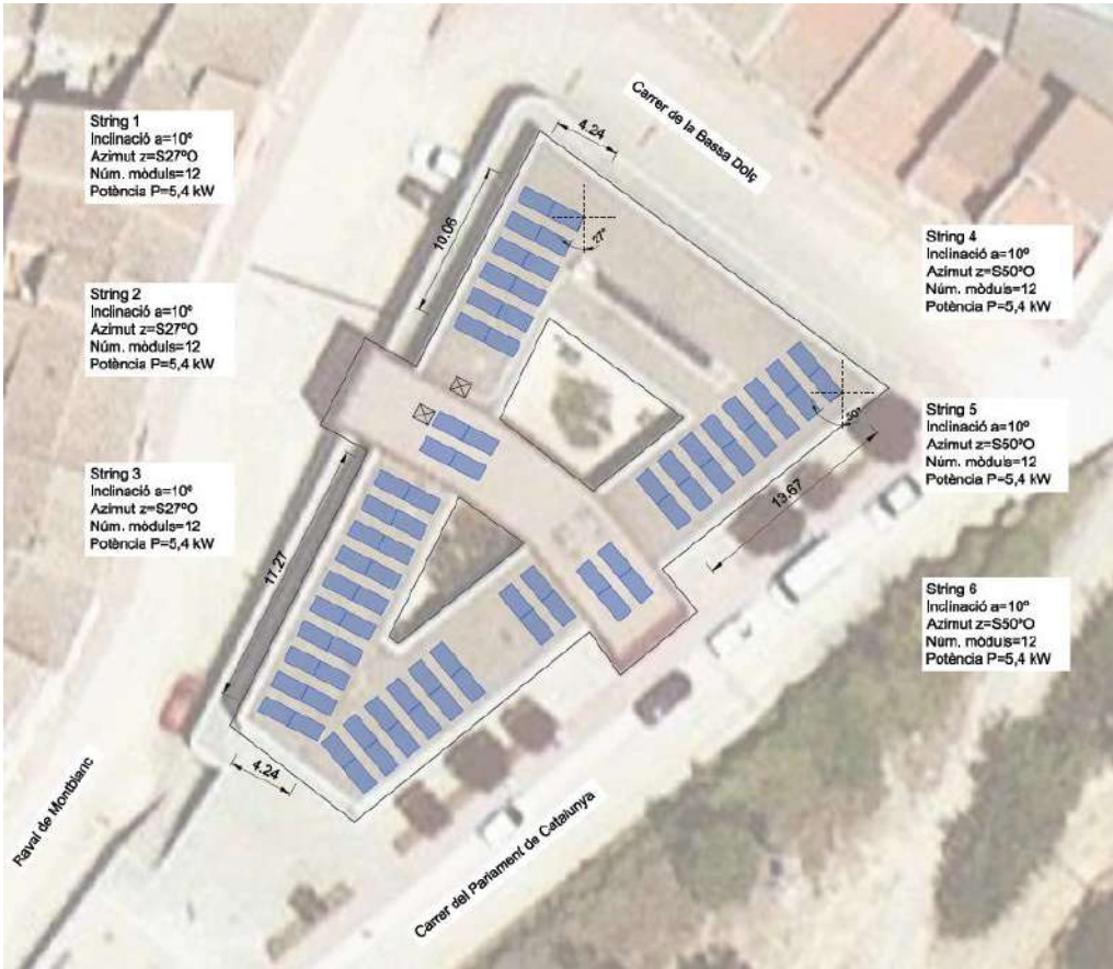
Emplaçament, superfície d'ocupació i orientació dels mòduls solars respecte al sud
