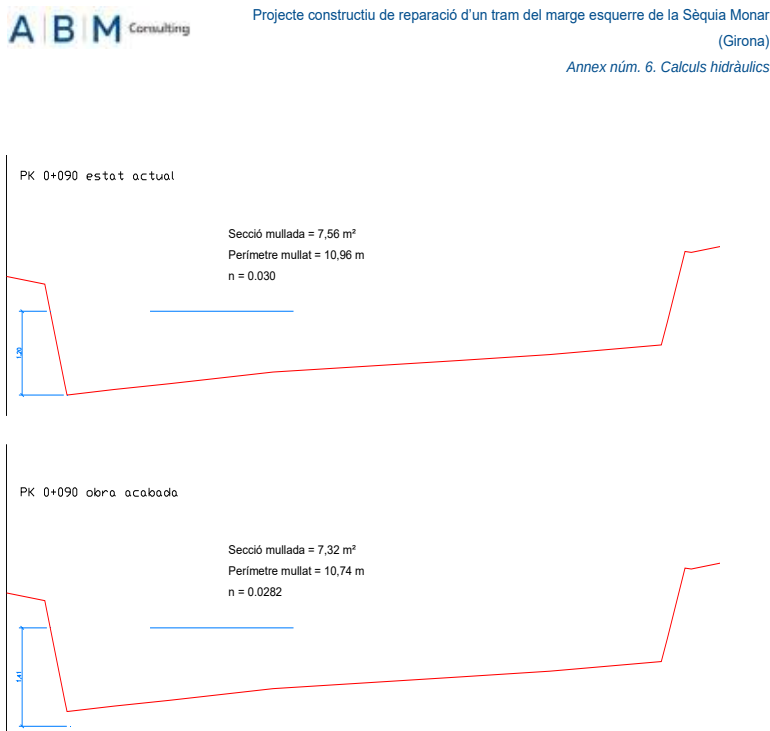
Figura 2. Caracterització geomètrica de la secció del PK0+090.
