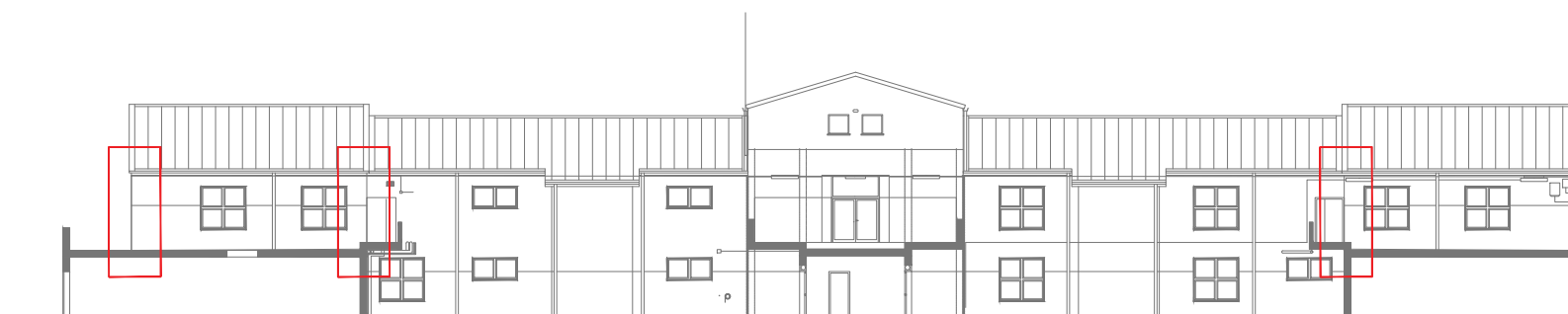
FAÇANA NORD-CANTONADES AMB ESQUERDES VERTICALS
