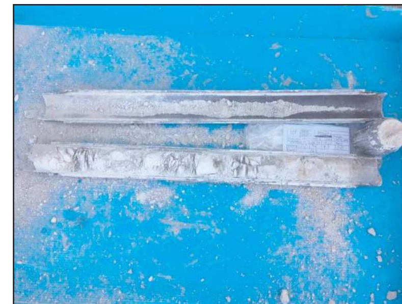
Fotografia 3. Material recuperat en l'assaig SPT-1 en el sondeig S-1 entre les cotes de -1.00 a -1.60 metres de profunditat.
