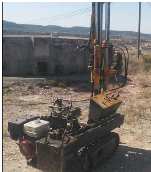
Fotografia 1. Vista de la màquina utilitzada per a la realització del assaig de penetració dinàmica DPSH.
