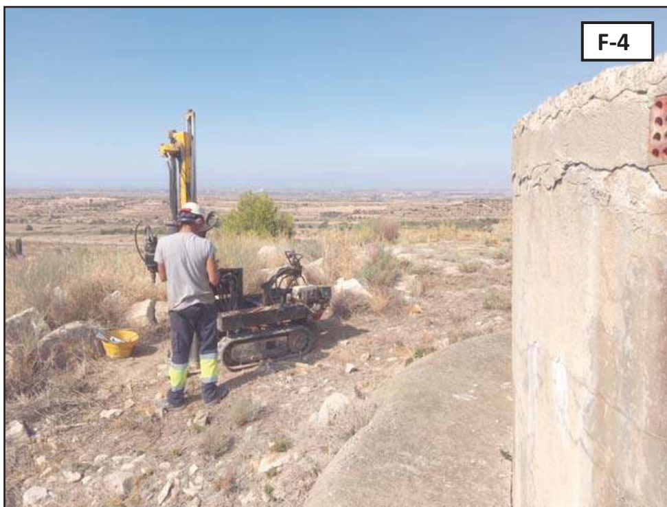
Fotografies 3 i 4: Detall de l'emplaçament de la màquina realitzant els diferents assaigs de penetració dinàmica, P-1 i P-2 respectivament.
