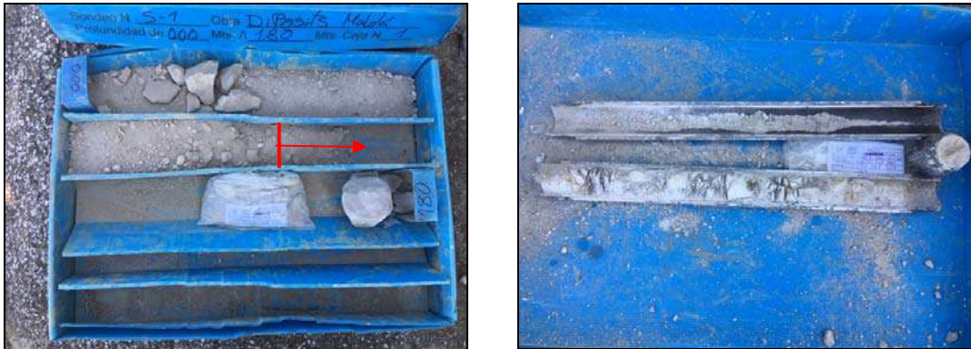
Fotografia 6 i 7. Detall dels materials extrets en el sondeig a rotació i en els materials recuperats en l'assaig SPT, on s'observa els materials del 1er nivell.
