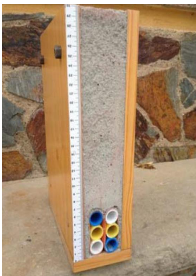
Ex. de secció de microrasa de 6x20mm amb reblert de morter
