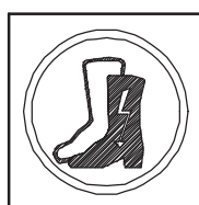
PROTECCION OBLIGATORIA DE LOS PIES (BOTAS DIELECTRICAS)
