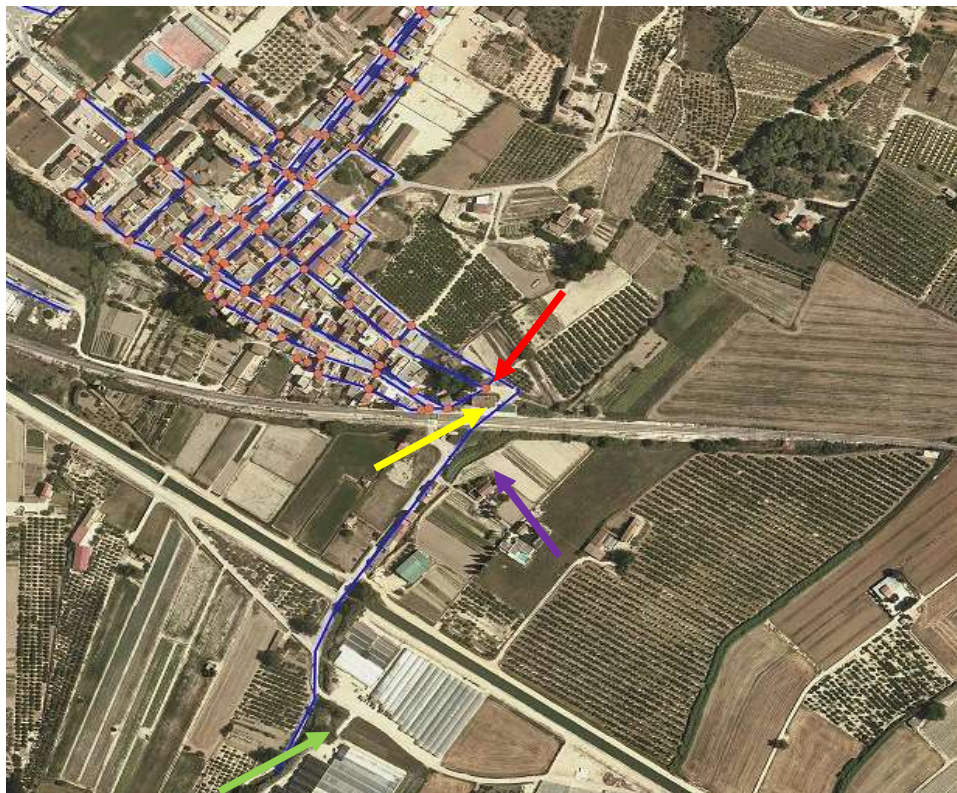
Imatge 1. Es mostra amb fletxa color roig: ramal 1, fletxa color groc: ramal 2, fletxa color lila: unió ramals, fletxa color verd: sortida sistema sanejament.
