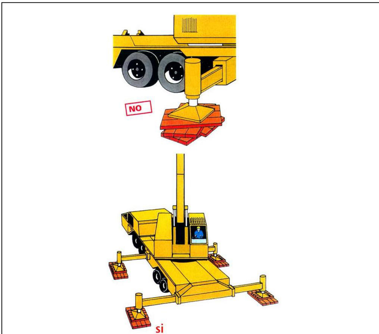
Col·locació estabilitzadors recolçaments
