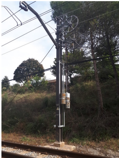
Imatge 1: Sistema de compensació doble ECP-2 a la sortida de l'estació de La Pobla de Claramunt.
