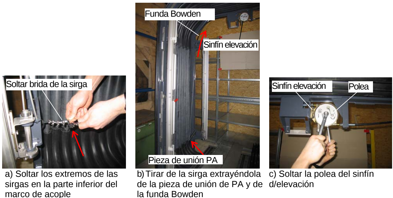
Figura 29: Sustitución de las poleas y sirgas metálicas (esquemático)
