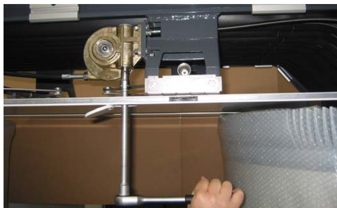
b) Accionamiento del dispositivo de elevación mediante carraca y prolongación.
